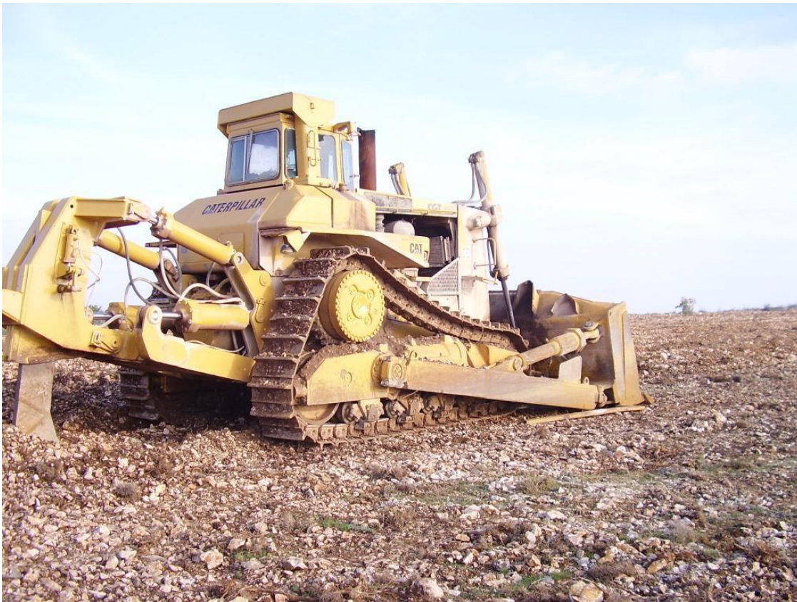
Slika 5. Buldožer s podriivačem (Izvor: Rajner Perica)
