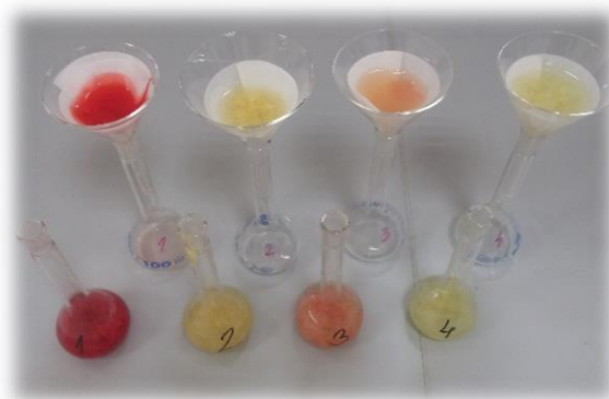
Slika 14. Filtriranje uzoraka kroz filter papir (Slikala: Martina Pejić)
