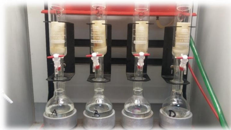
Slika 17. Određivanje udjela masti pomoću Soxhlet ekstraktora (Slikala: Martina Pejić)
