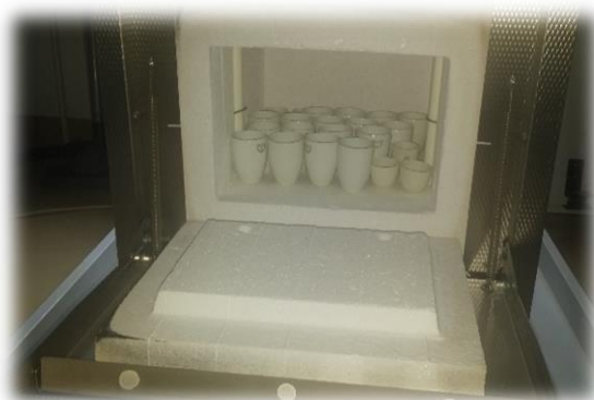
Slika 12. Mufolna pećnica (Slikala: Martina Pejić)
