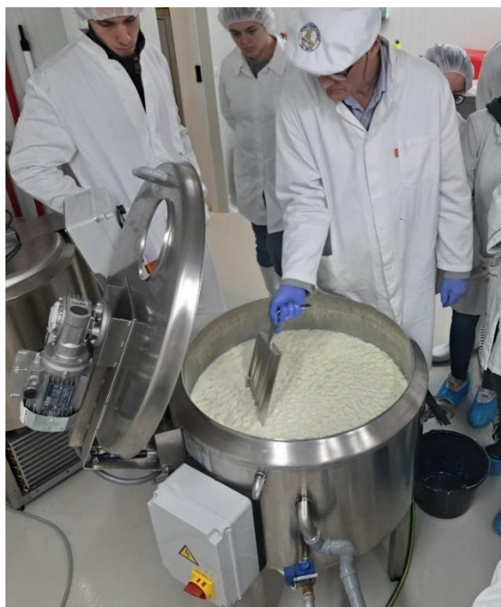
Slika 4.1. Proces rezanja gruša sirarskom harfom
