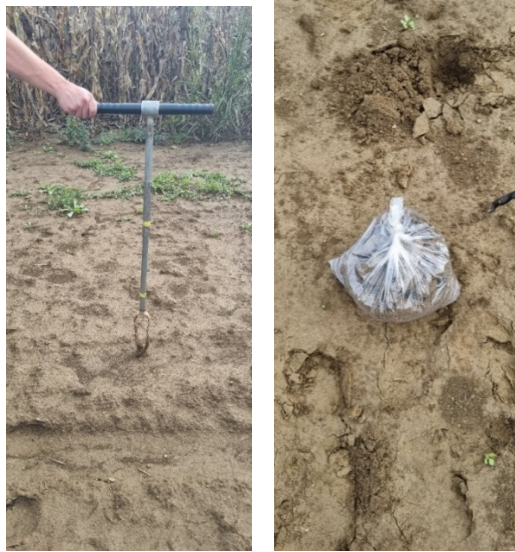
Slika 2.5.1. Uzorkovanje tla pedološkom sondom (lijevo) i uzorci tla (desno)
