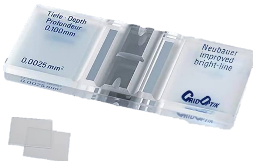
Slika 7. Hemocitometar s dva pokrovna stakalca u lijevom kutu slike
