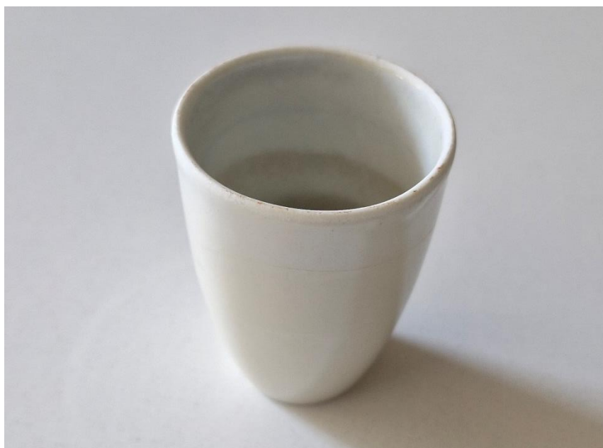
Slika 8. Porculanski lončić za određivanje pepela
