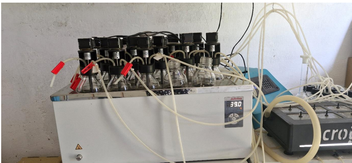
Slika 17. Uzorci na anaerobnoj digestiji pri 39 °C
