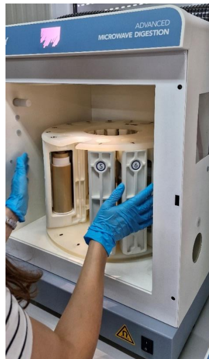
Slika 14. Mikrovalni sustav za zatvorenu digestiju (a,b)
