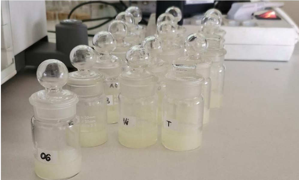
Slika 6. Posudice s uzorcima pripremljene za sušenje Izvor: Vlastita arhiva
