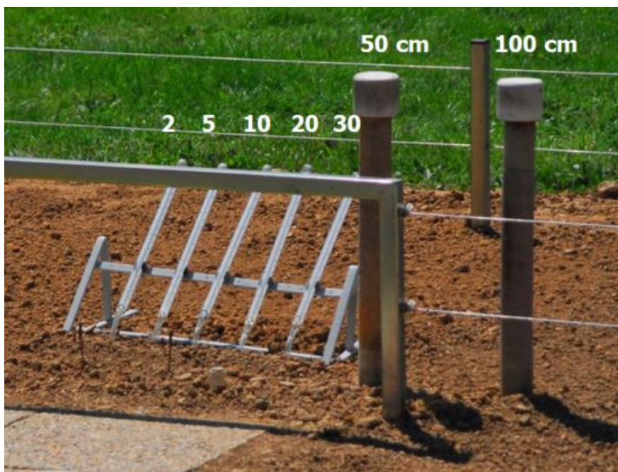
Slika 2.2.2. Geotemperaturno polje s geotermometrima. Instrumenti dubine do 30 cm su klasični koljenasti živi termometri, a na 50 i 100 cm su živini termometri na izvlačenje
