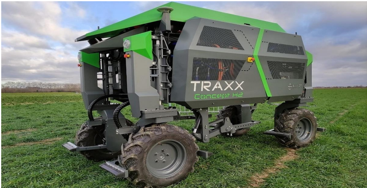
Slika 3.10. Robot Traxx Concept H2 s pogonom na vodik
