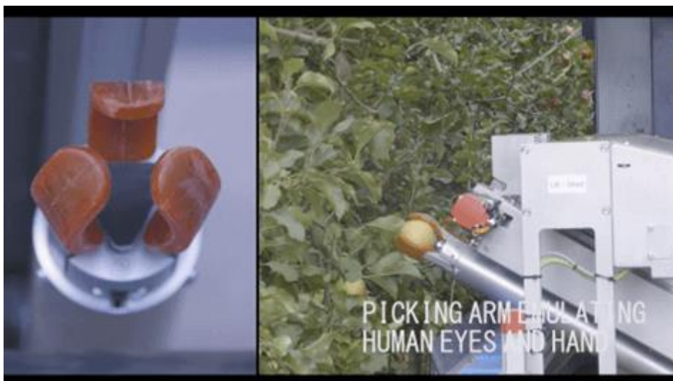
Slika 8.5. Hvataljka i robotska ruka autonomnog berača voća FFRobot
