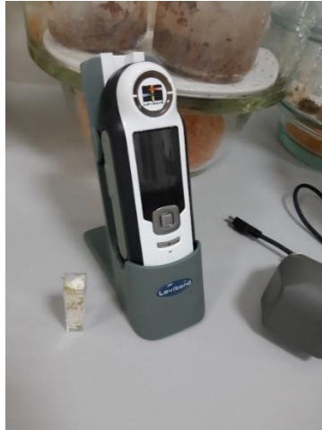
Slika 9. Kolorimetar LC 100 Spectrocolorimeter(vlastiti izvor)
