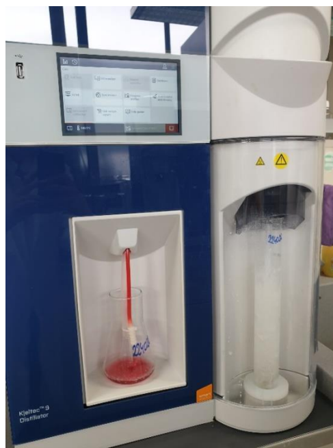
Slika 3.1.7. Destilacija uz pomoć Kjeltec uređaja Foto: M. Pejić
