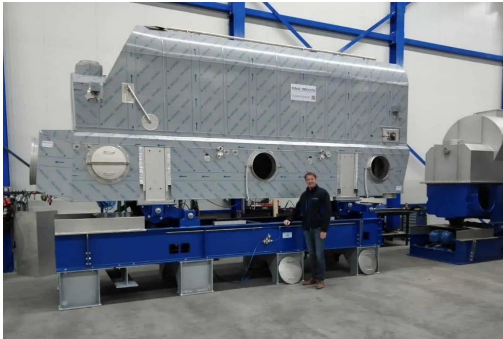
Slika 4.1.1. Stroj za tretiranje sjemena vrućim zrakom
