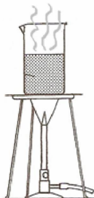
Slika 22. Grijanje uzorka razrije enog destiliranom vodom do vrenja
