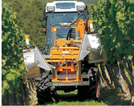
Slika 2.4.1. Provođenje defolijacije pomoću defolijatora (Izvor: https://www.agrosad-germany.com/defolijacija/?lang=hr )
