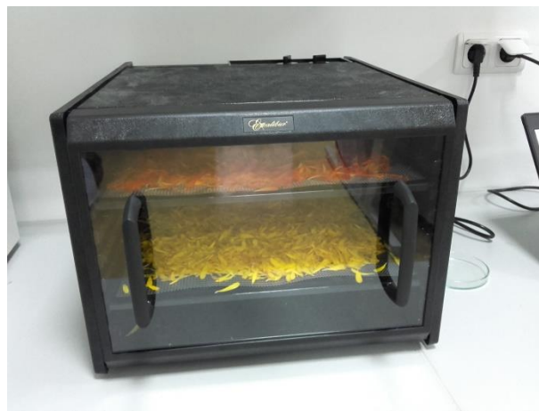
Slika 20: Dehidriranje cvjetova nevena u dehidratoru
