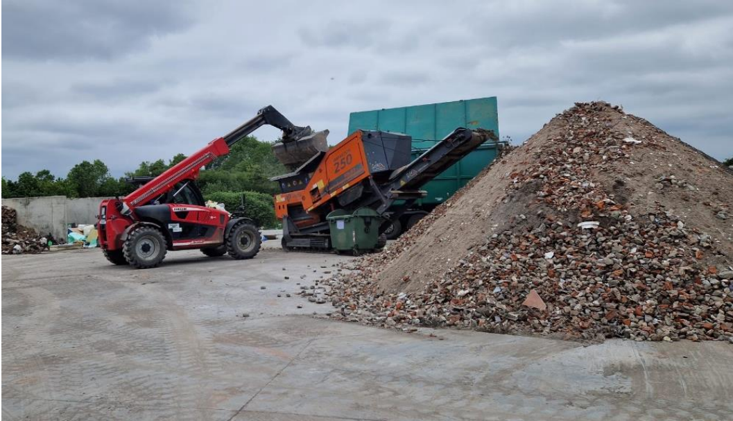
Slika 14. Prikaz usitnjavanja građevinskog otpada Izvor: E. Nekret-Katić, 2023.
