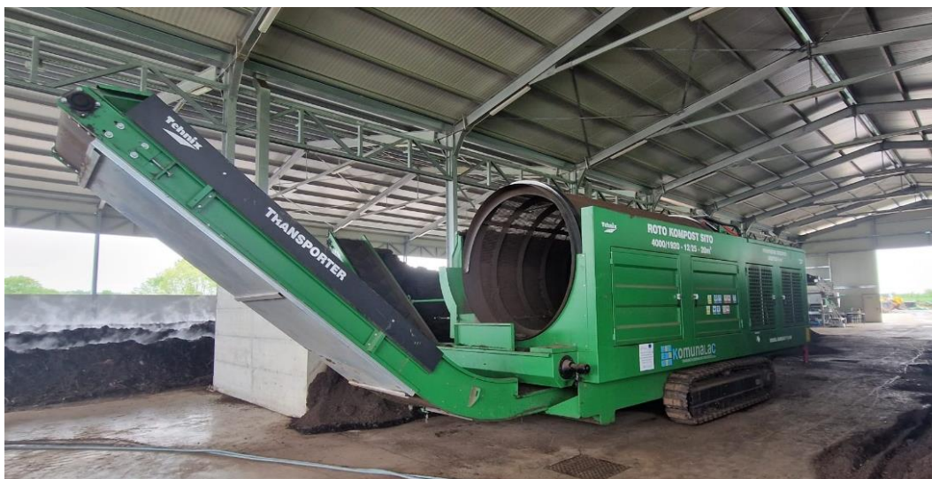
Slika 18. Prikaz stroja za prosijavanje komposta Izvor: E. Nekret-Katić, 2023.
