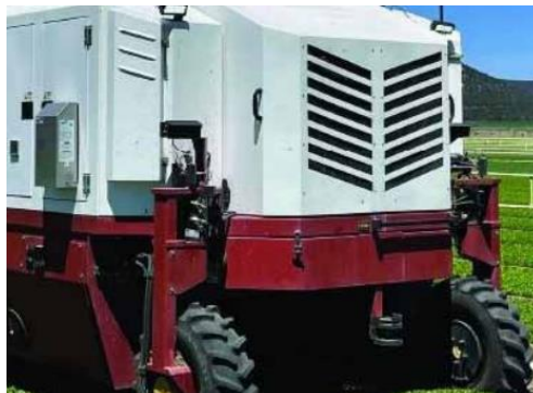
Slika 3.2. Treći autonomni robot tvrtke Carbon Robotics za suzbijanje korova pomoću laserske tehnologije
