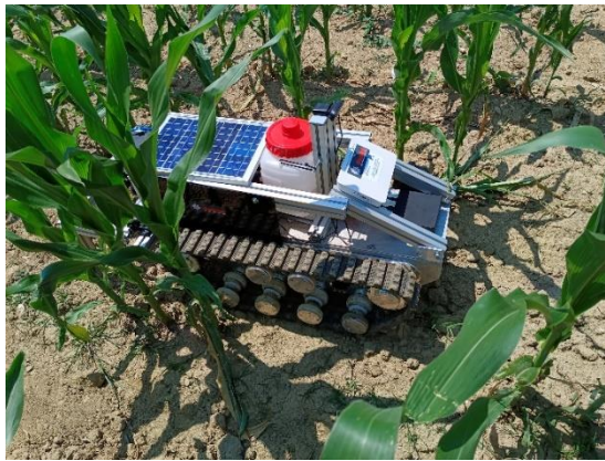
Slika 3.3. cRobot - robot za prepoznavanje i ekološko tretiranje korova
