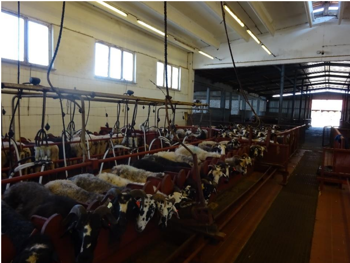
Slika 2.1.4.1. Strojna mužnja istarskih ovaca
