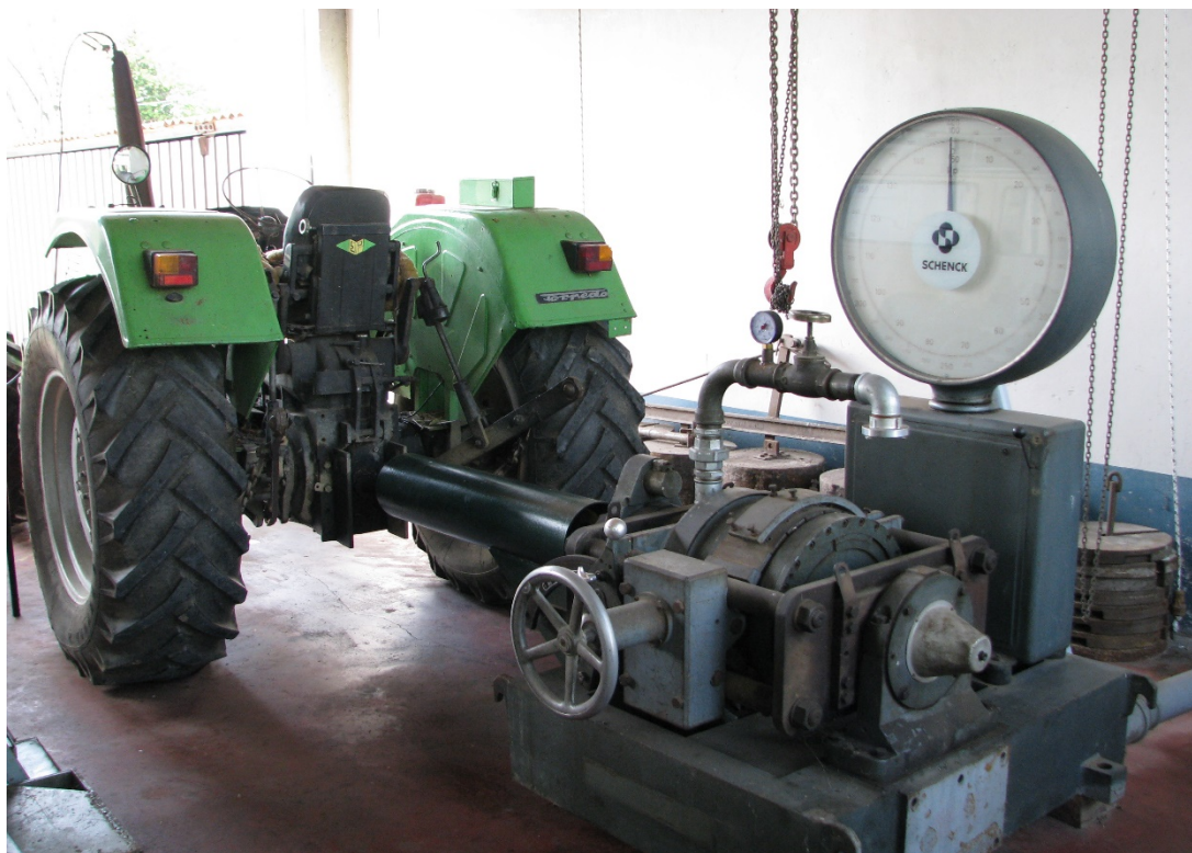
Slika 27. Ispitivanje snage motora traktora na priključnom vratilu s hidrauličkom kočnicom
