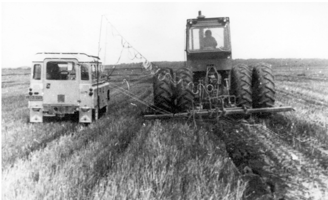
Slika 20. Provedba mjerenja otpora oruđa. Foto I. Antončić
