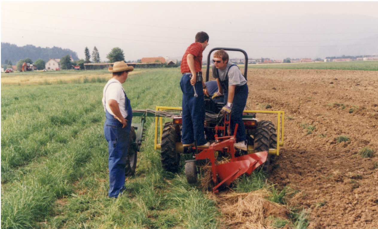
Slika 28. Podešavanje i priprema pluga za ispitivanje traktora u oranju, 2004.
