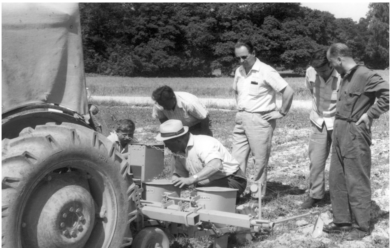
Slika 23. Provjera kvalitete rada mehaničke sijačice za okopavine 1960.-1970.
