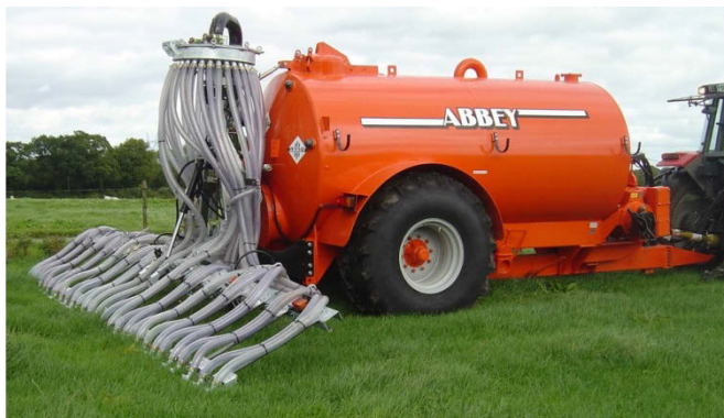
Slika 12. Injektiranje tekućeg stajskog gnoja u tlo (Izvor: http://clovellycontractors.com/agriculturalservices/silage )
