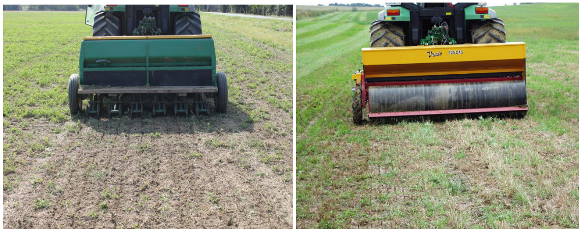
Slike 8 i 9. Sijačice za direktnu sjetvu travnjaka
