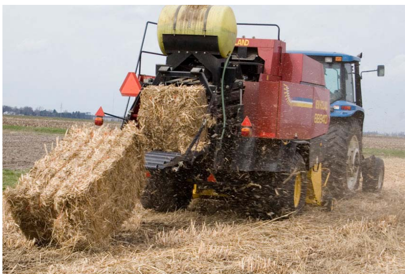
Slika 51. Prešanje četvrtastih bala ( https://illinois.edu/blog/view/6367/205160 )
