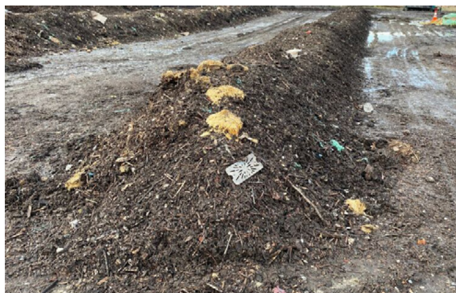
Slika 52. Kompostiranje mulja na otvorenom ( www.sludgeprocessing.com )
