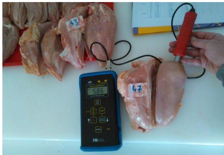
Slika 5. Mjerjenje pH vrijednosti (izvor: vlastito istraživanje)
