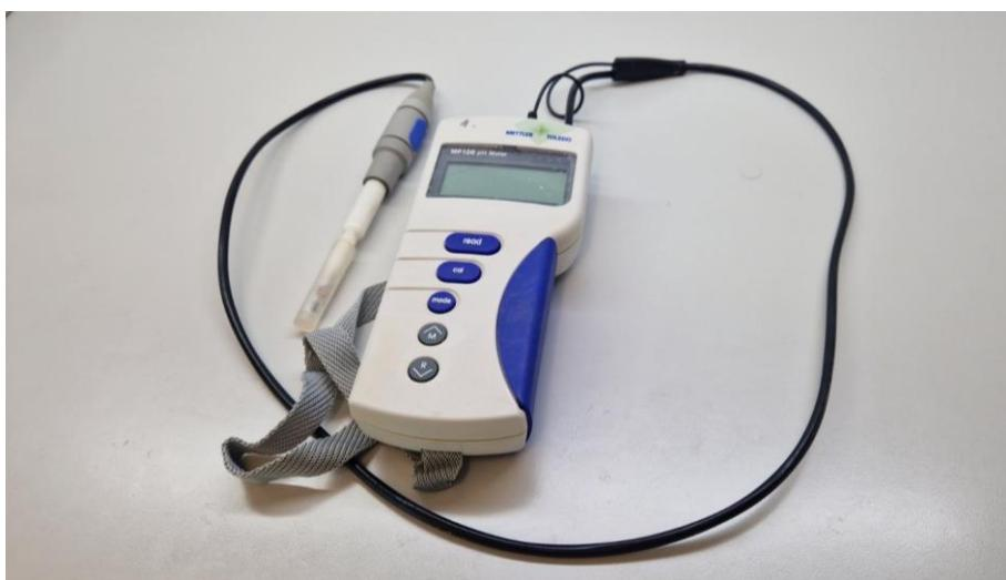
Slika 20. Digitalni pH-metar Mettler MP120-B (Izvor: Z. Kralik)
