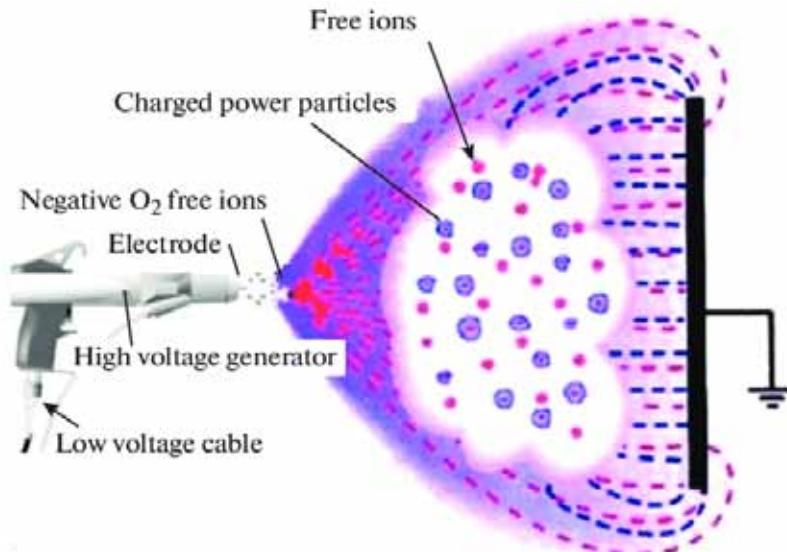
**Slika 10.** Shema procesa elektrostatske zaštite putem ručnog uređaja (Izvor: Golgoon i sur., 2018.)
