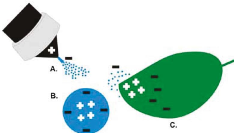
**Slika 5.** Princip raspodjele elektrostatickih nabijenih čestica na lisnu masu (Izvor: sprayers101.com)
