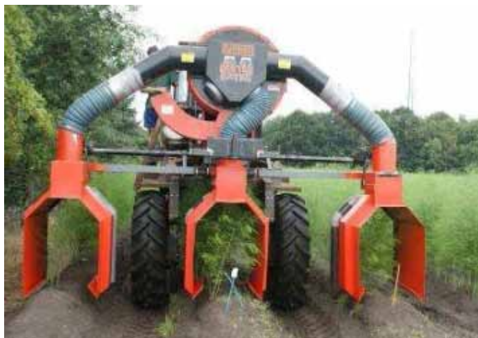
Slika 1. Pneumatski sustav prikupljanja štetnika (Izvor: www.plantenziektekunde.nl )
