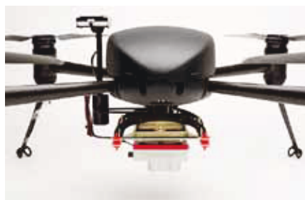
Slika 7. RTK senzor ugrađen na bespilotnoj letjelici
