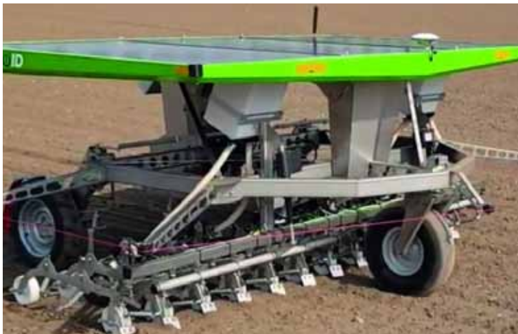
Slika 5. Robot za mehaničko suzbijanje korova FarmDroid FD20
