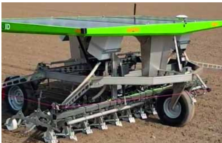
Slika 5. Robot za mehaničko suzbijanje korova FarmDroid FD20
