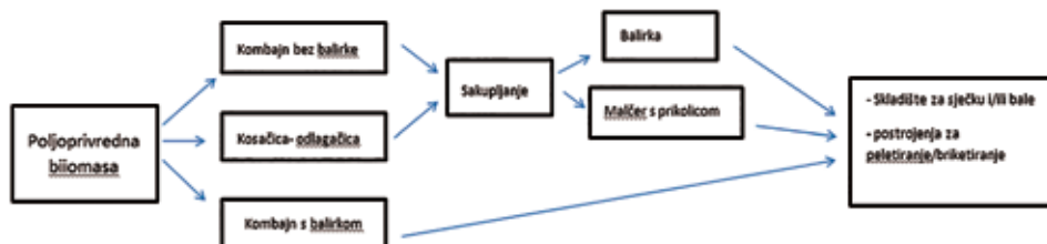
Slika 4. Shematski prikaz proizvodnje sječke, bale i peleta/briketa (izvor: vlastita arhiva)
