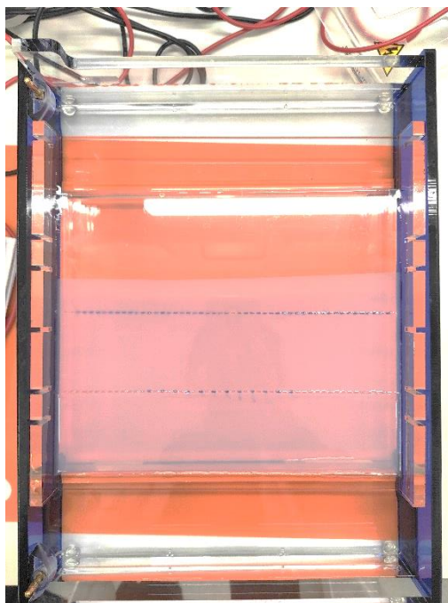
Slika 13. Uzorci DNA stavljeni na gel elektroforezu.
