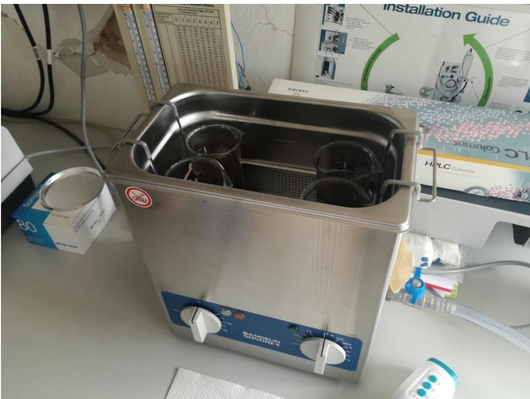
Slika 3.2.2. Ultrazvučna kupelj
