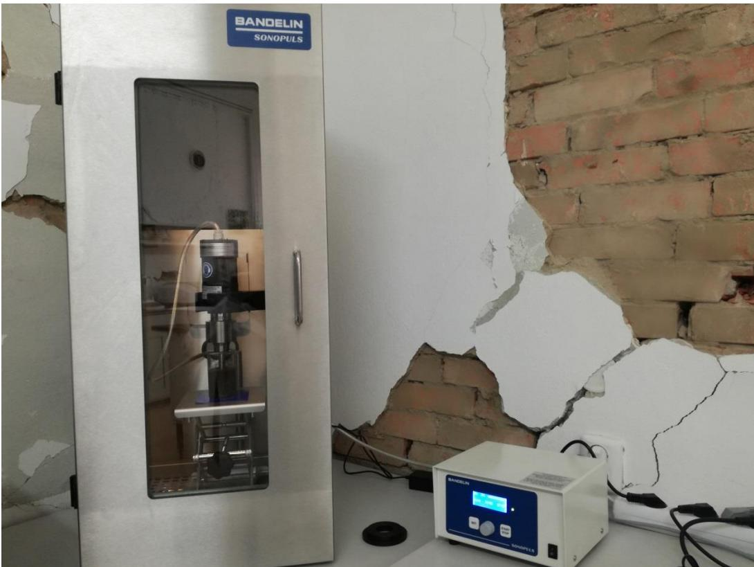
Slika 3.2.1. Ultrazvučna sonda
