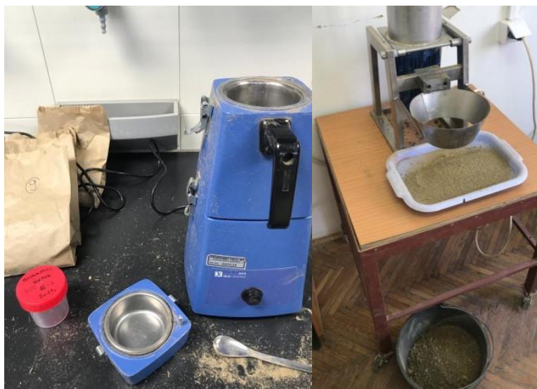
Slika 4.6.7. Mljevenje uzoraka nadzemne biomase i tla u ožujku 2021. godine
