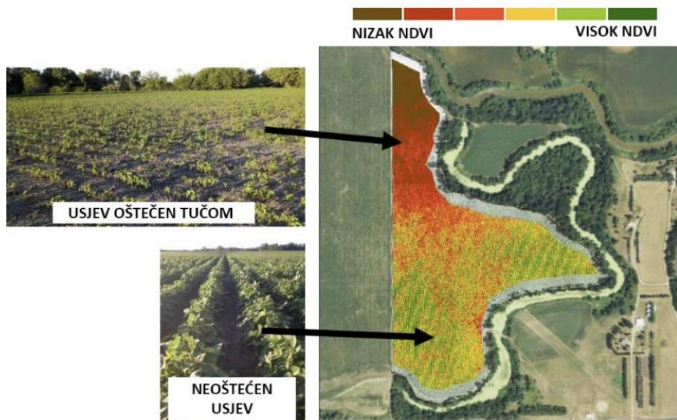
Slika 4.1.2. Prikaz razlike NDVI indeksa, snimljenog senzorskom kamerom na UAV-u, primjer usjeva pod stresom zbog klimatske nepogode.
