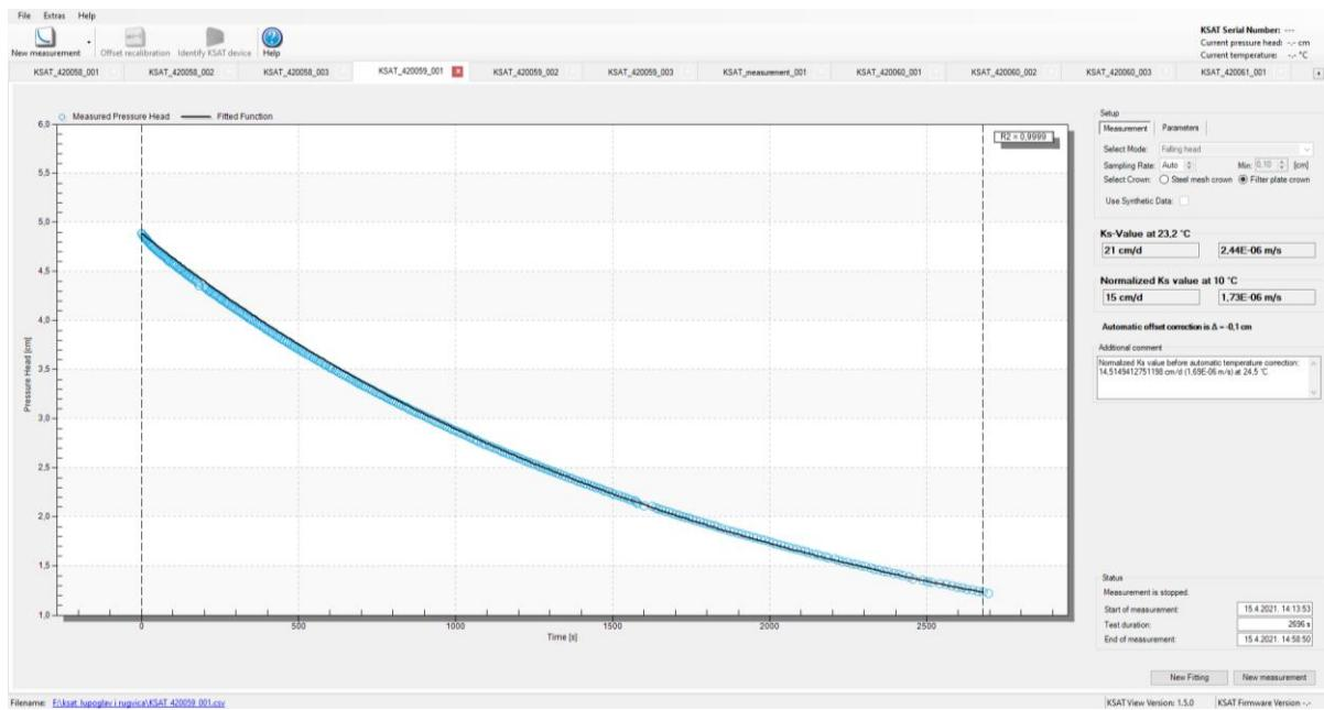
Slika 11. Prikaz krivulja vodopropusnosti u računalnom programu K-SAT
