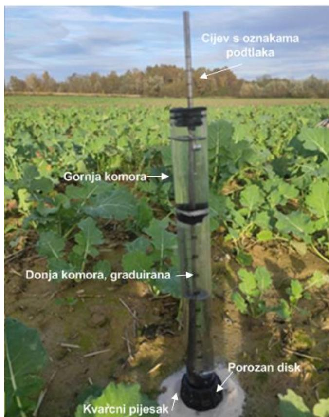
Slika 7. Prikaz mjerjenja infiltracijske sposobnosti tla pomoću mini disk infiltrometra
