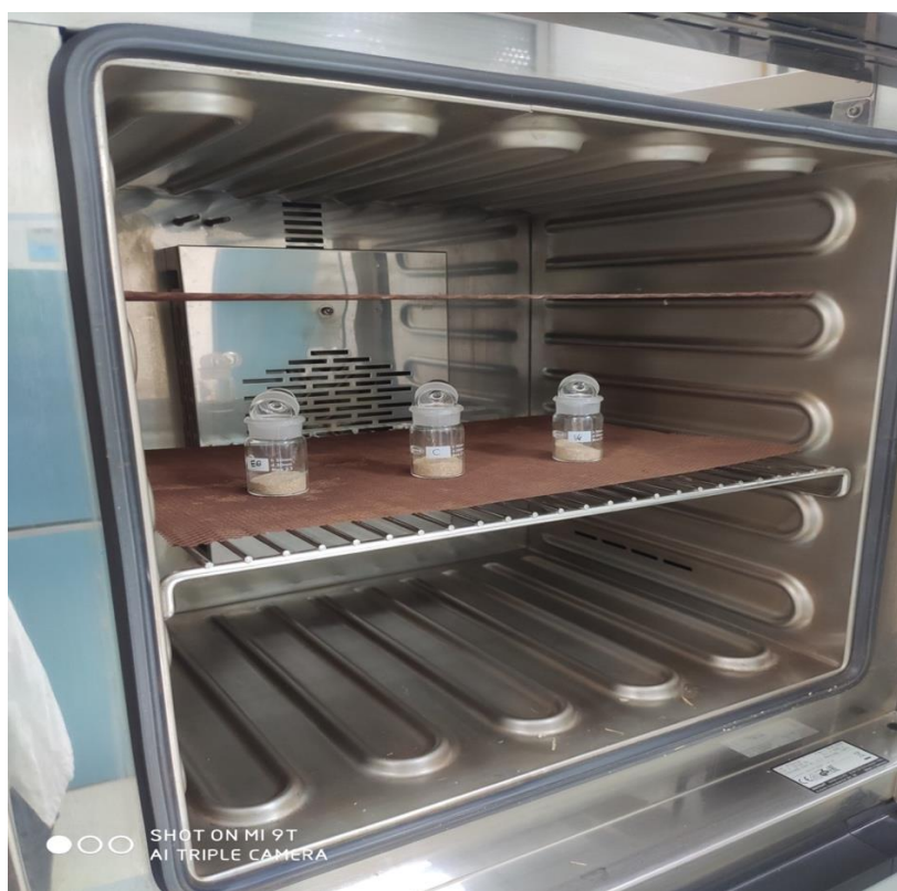
Slika 9. Postavljeni uzorci za sušenje u sušnici
