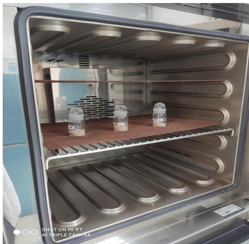
Slika 9. Postavljeni uzorci za sušenje u sušnici
