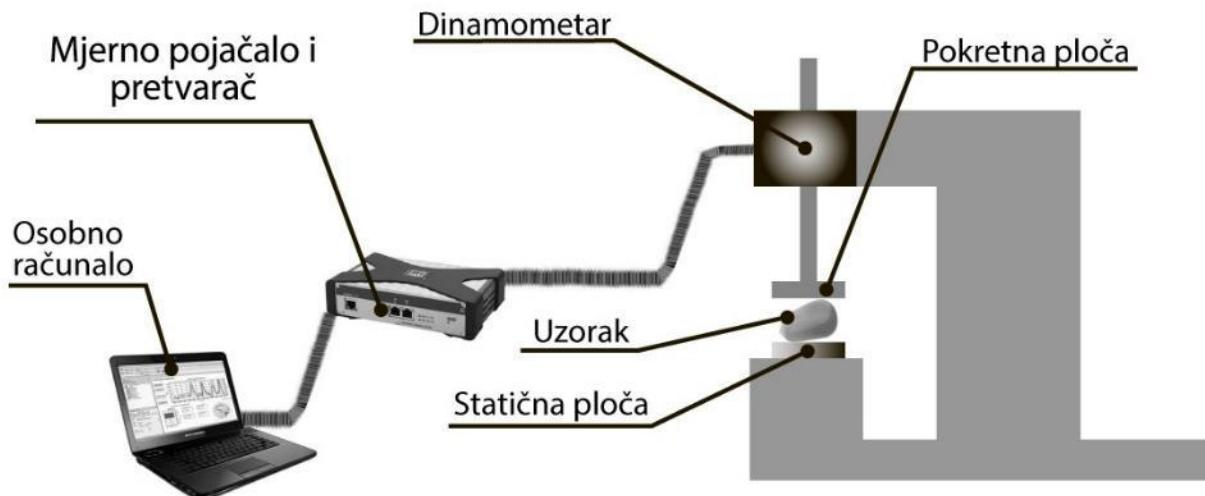
Slika 2.5. Shematski prikaz uređaja za lomljenje zrna
