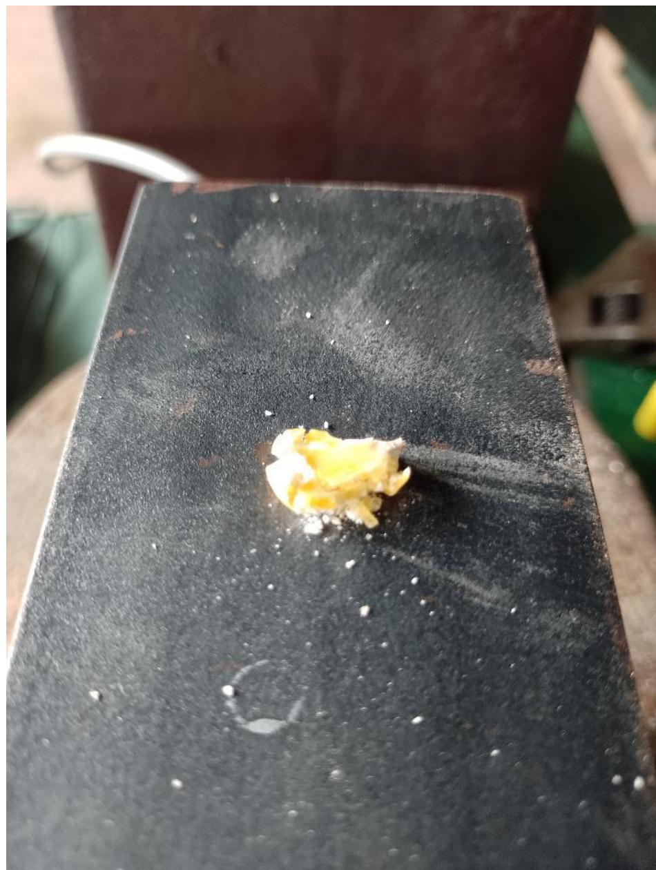
Slika 2.4. Zrno nakon određivanja sile lomljenja
