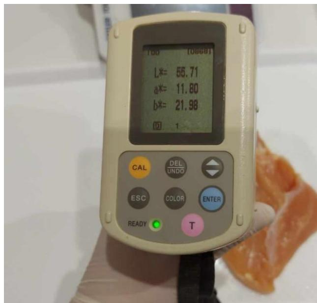
Slika 3.4. Mjerenje boje mesa ( $L^*$ ,  $a^*$  i  $b^*$ ) pomoću Minolta kolorimetra s 50 mm dijametarskim područjem mjerena
