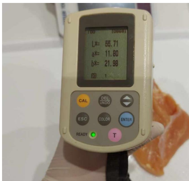
Slika 3.4. Mjerenje boje mesa ( L^* , a^* i b^* ) pomoću Minolta kolorimetra s 50 mm dijametarskim područjem mjerenja
