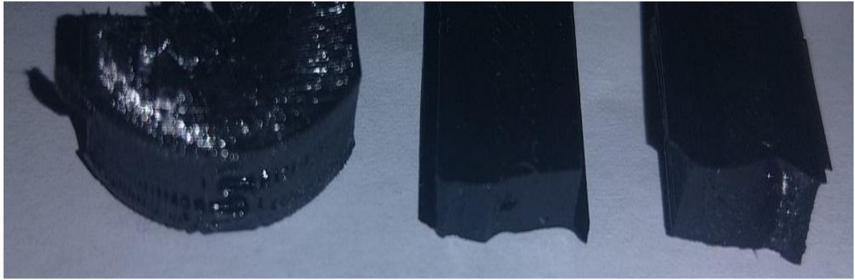
Slika 12.1. Primjer makro i mikro šupljina nastalih prilikom trodimenzijskog ispisa
