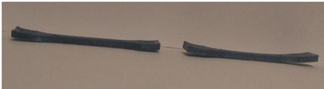
Slika 1.1. Primjer povijanja trodimenzijski ispisi predmeta tijekom ispisa
