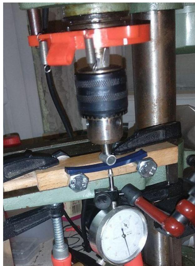
Slika 11.9. Ispitivanje uzorka prema standardu ISO 178
