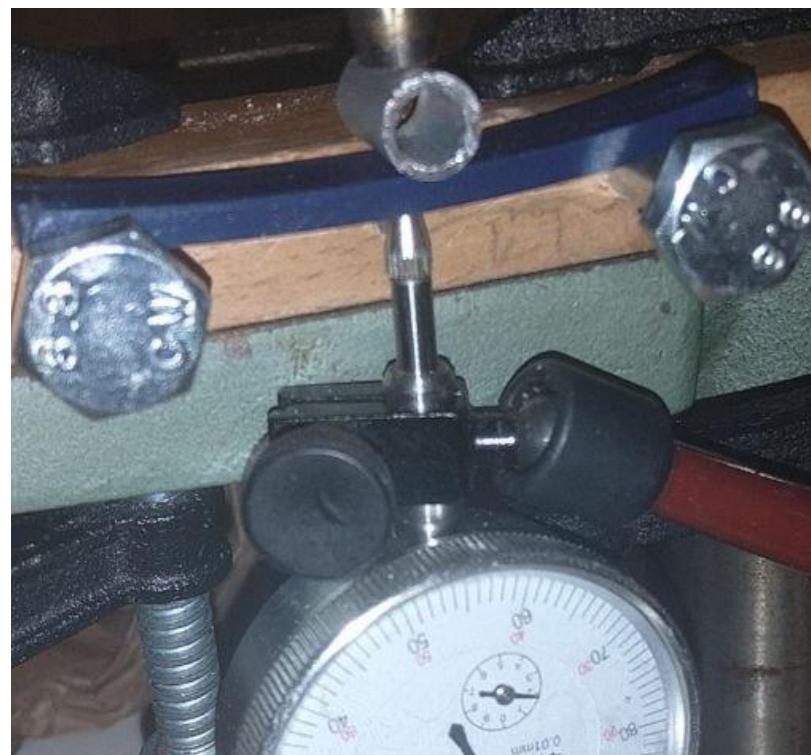
Slika 11.10. Fotografija otklona nastalog na uzorku prilikom ispitivanja
