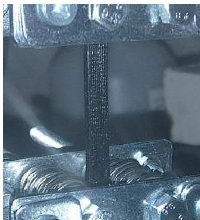
Slika 11.8. Fotografija ispitivanja uzorka 1BA neposredno prije postizanja najveće sile
