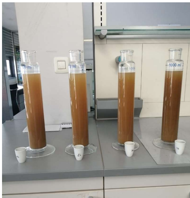
3.3.4. Cilindri za sedimentaciju pripremljeni za pipetiranje praha i gline (foto: Adelisa Smajć, 2023.)
