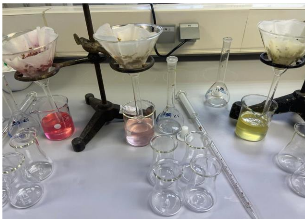
Slika 3.2.2.1. Prikaz postupka za vitamin C- filtracija uzorka nakon koje slijedi pipetiranje u 4 tikvice (foto M. Vrbanić)
