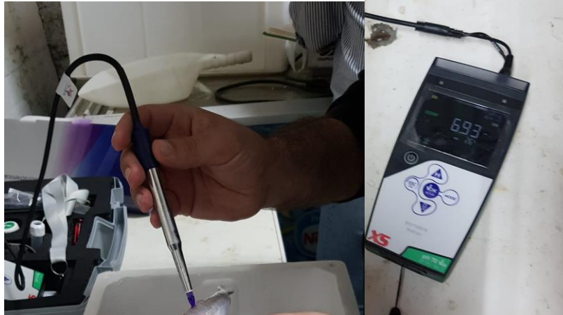
Slika 4. Mjerenja pH muskulature ribe ubodnim pH metrom
