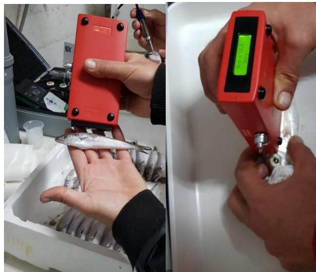
Slika 3. Mjerenje dielektričnih svojstava/provodljivosti torimetrom
