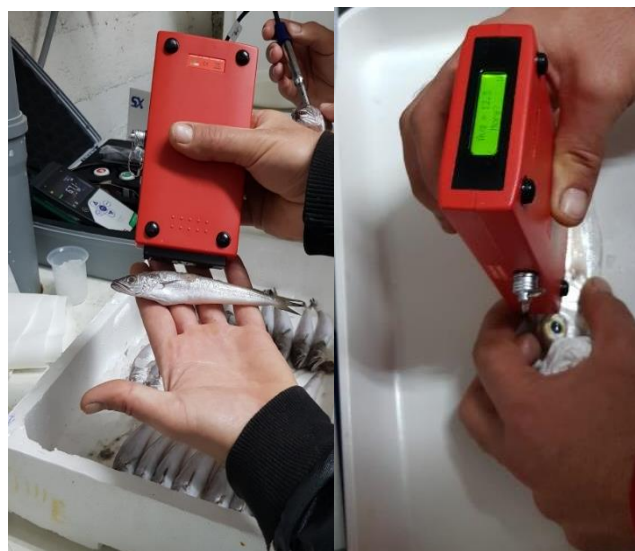
Slika 3. Mjerenje dielektričnih svojstava/provodljivosti torimetrom
