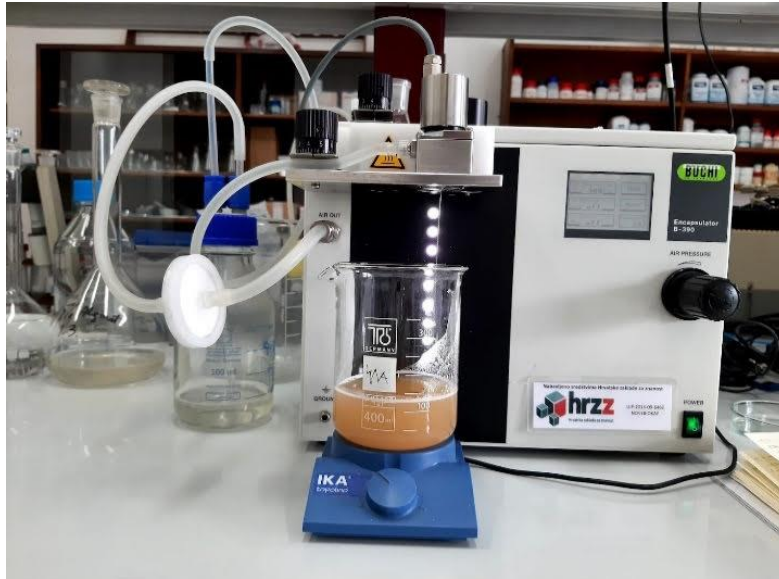
Slika 3.3. Proces inkapsulacije metodom ionskog geliranja na inkapsulatoru
