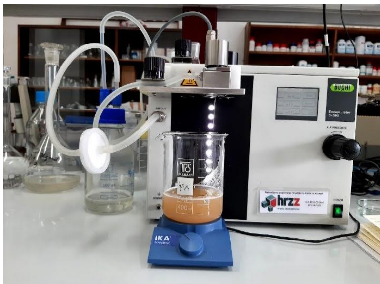
Slika 3.3. Proces inkapsulacije metodom ionskog geliranja na inkapsulatoru
