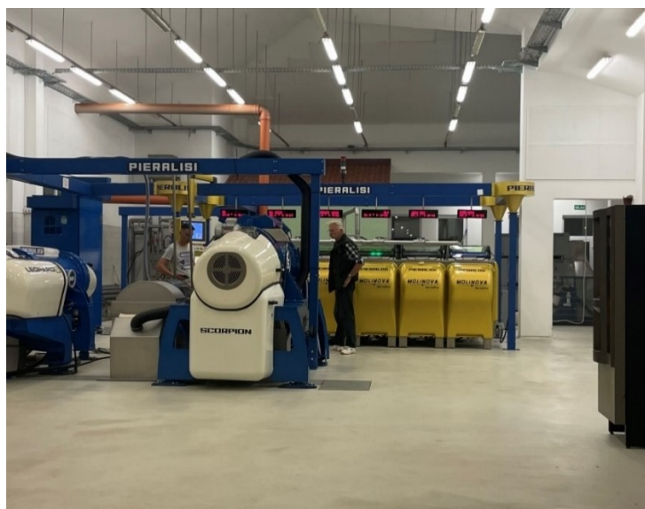
Slika 2.5. Uljara s dvofaznim sustavom prerade maslina u Poličniku
