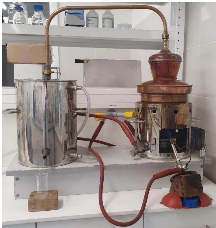
Slika 3.7. Jednostavni destilacijski *alambic* uređaj kapaciteta 5 L
