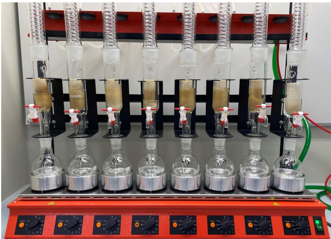
Slika 23. Ekstrakcija na Soxhlet uređaju
