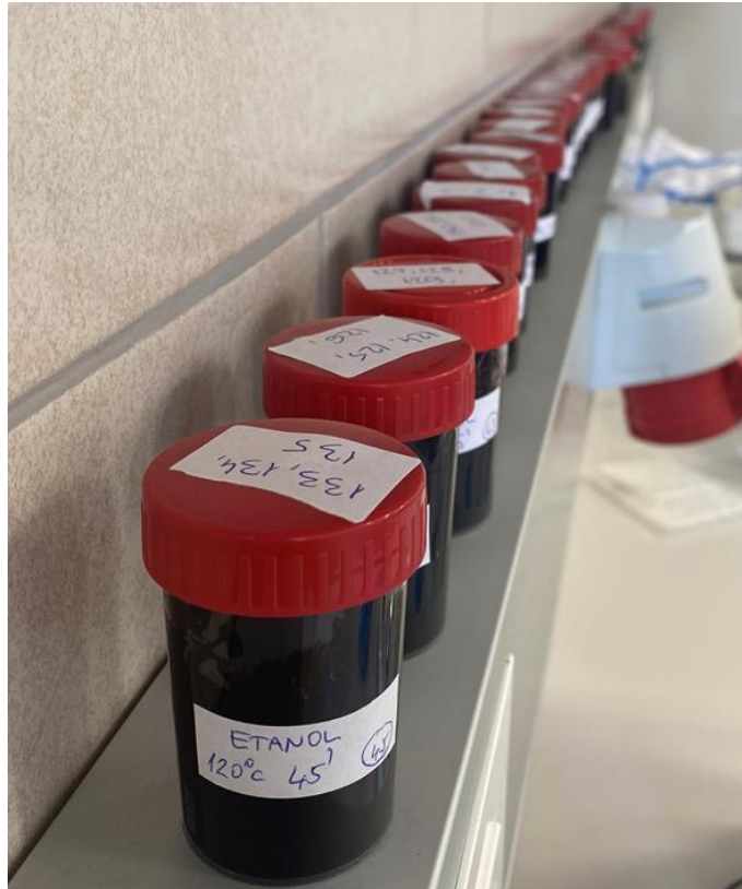
Slika 34. Utekućena biomasa ljuske oraha pripremljena za daljnje analize
