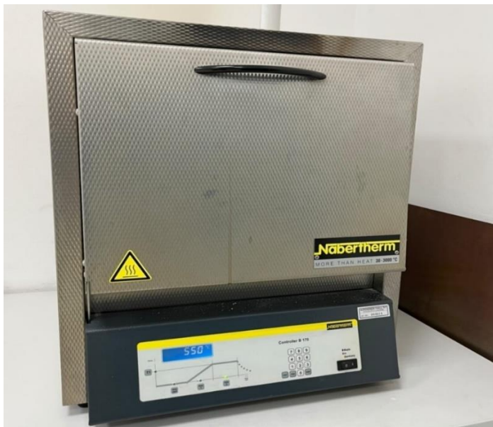
Slika 12. Mufolna peć Nabertherm B170 (izvor: vlastiti izvor)
