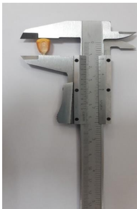
Slika 10. Mjerenje dužine, širine i debljine pomoću šublера (izvor: vlastiti izvor)
