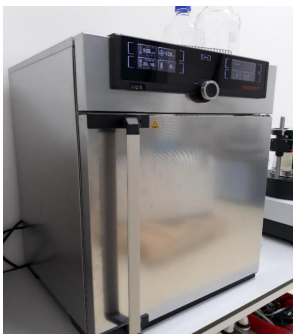
Slika 3.2.3.3. Laboratorijska sušnica (Mettmert, Njemačka)
