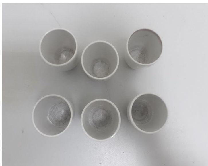
Slika 3.2.4.2. Uzorci N. oculata i I. galbana nakon žarenja
