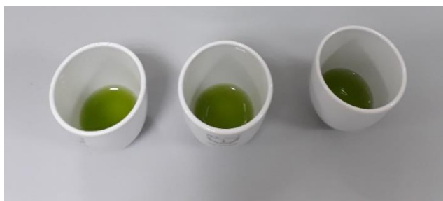
Slika 3.2.3.2. Izvagani triplikati uzorka N. oculata u lončićima prije sušenja
