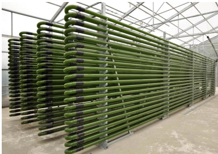
Slika 2.2.1.1. Zatvoreni sustav uzgoja - cjevasti fotobioreaktor
