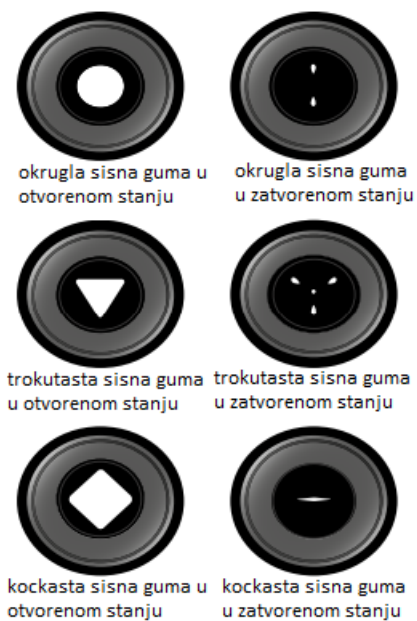
Slika 3.2.2. Prikaz oblika središnjeg dijela sisne gume u otvorenom i zatvorenom stanju
