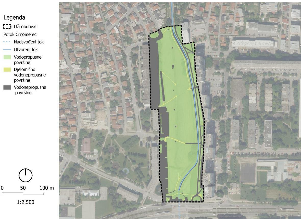
Slika 5.13. Analiza propusnosti površina, podzona Črnomerec
