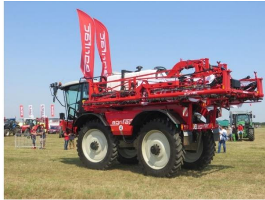
Slika 18. Nošena i samohodna prskalica (Izvor: www.messis.hr ; www.agroklub.com )
