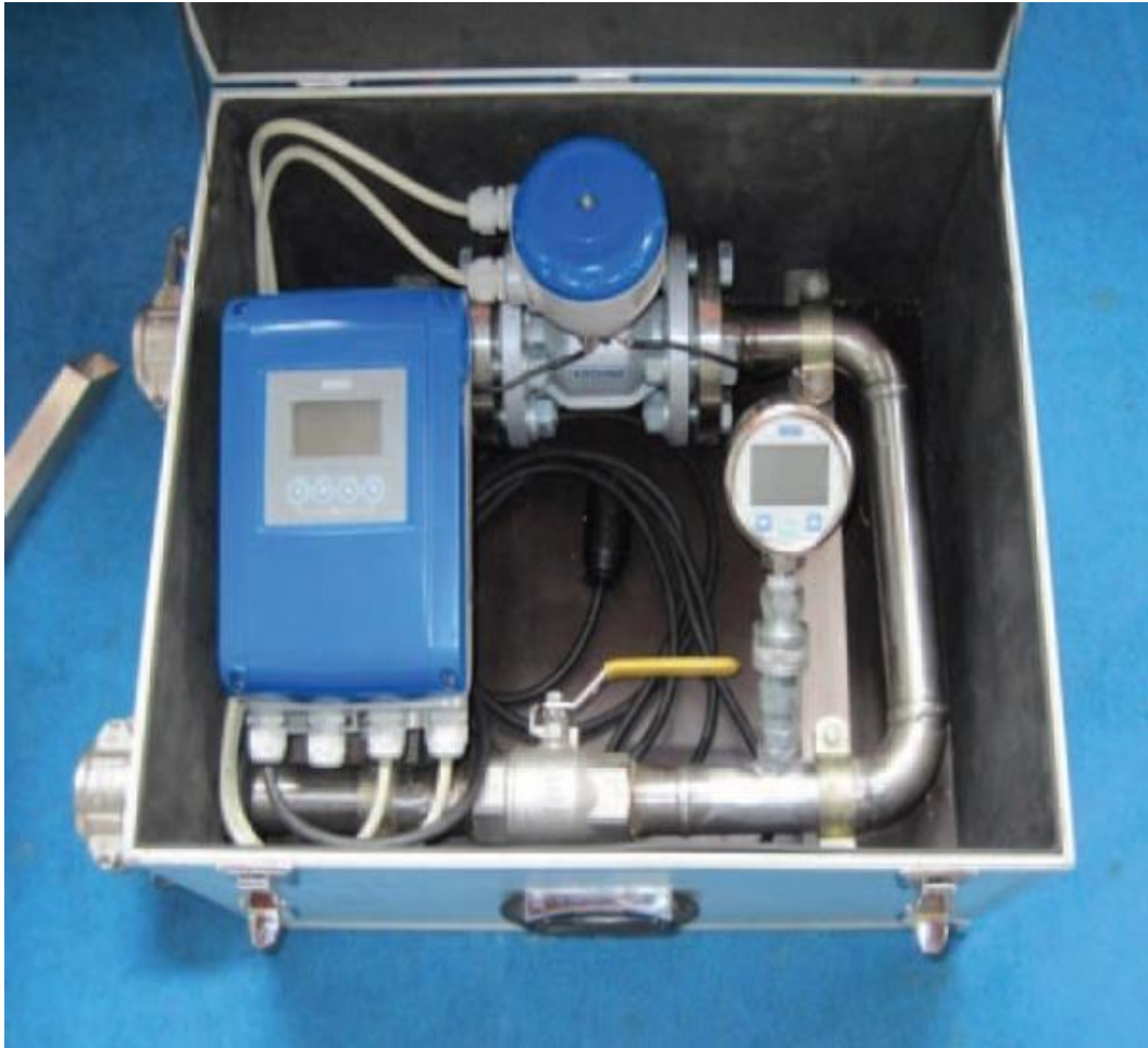
Slika 3. Uređaj za mjerenje protoka crpke (Izvor: www.sestar.irb.hr )
