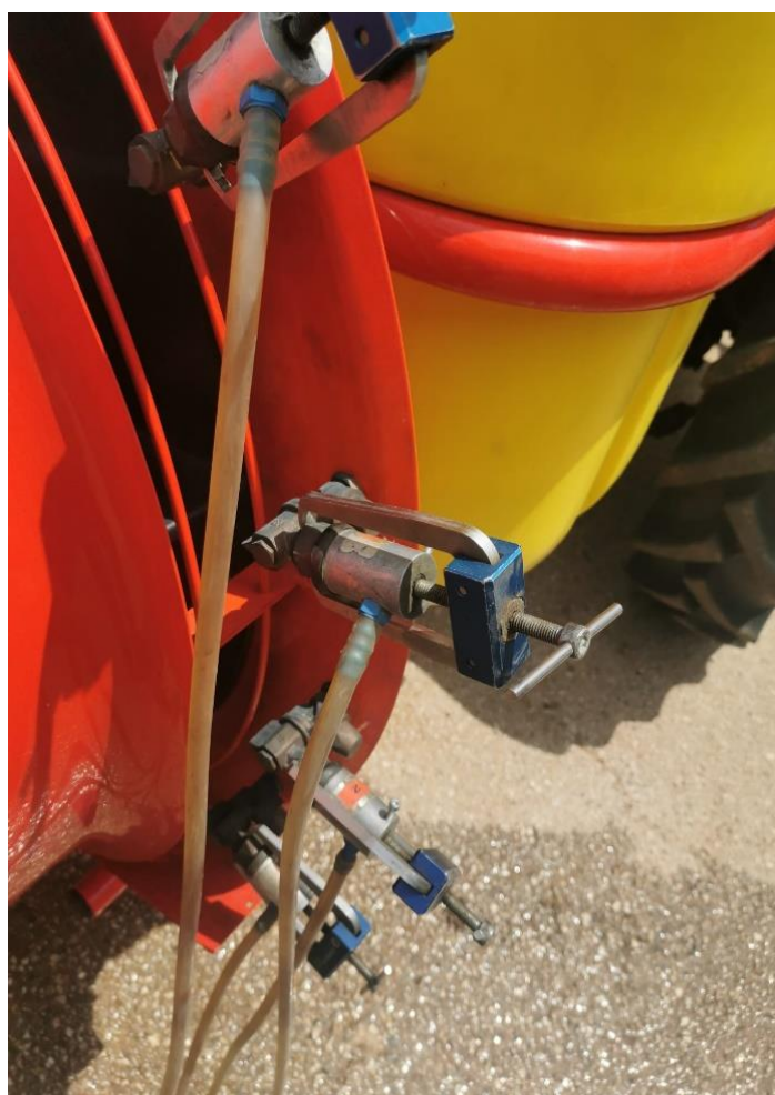
Slika 5. Priključak spojen s crijevom na mlaznicu (Autor: Ostojić, L.)
