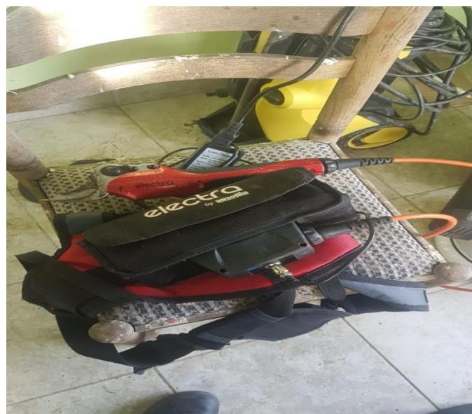
Slika 6: Električne škare za ručnu rezidbu
