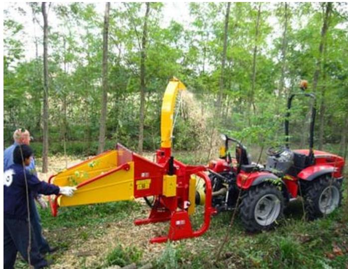
Slika 22: Stroj za usitnjavanje biljnih ostataka – model CPT 130
